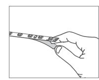
Remova a capa da fita dupla face e aplique-a. Não faça pressão sobre os componentes da fita LED.
