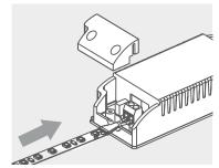
Conecte o cabo vermelho (+ positivo) e o cabo preto (- negativo) aos respectivos terminais da fonte (vendida separadamente).
